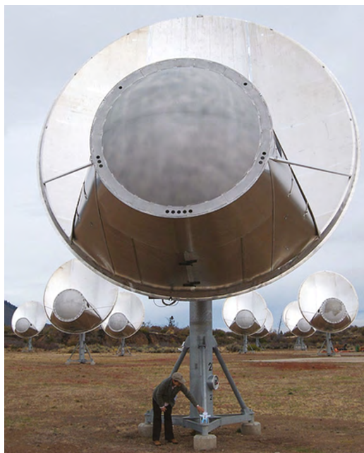
32 pav. Radijo teleskopo „Allen Telescope Array“, skirto radijo astronomijos projektams ir nežemiško intelekto paieškoms (SETI), antenos vaizdas.
